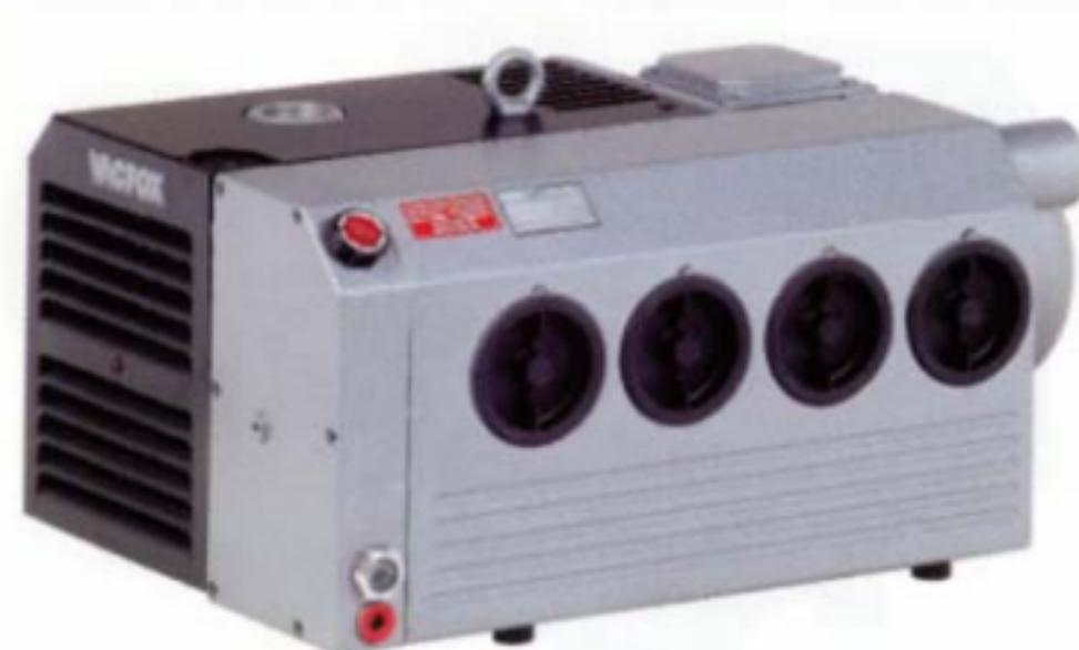
油润滑旋片式真空泵。流量从 50 至 180 m<sup>3</sup>/hr, 极限真空 0.1 mbar(绝对值)。法兰式电机, 转子两侧装有轴承, 装有油/气热交换器。内置筛网过滤器, 真空逆止阀, 气镇阀, 保护罩和油分离器。
